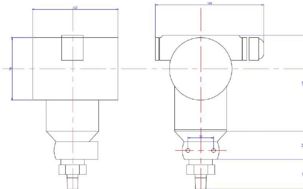
图 2—4 变送器外形尺寸图
