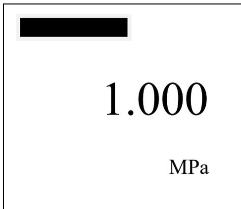
在测量状态，模式代码显示区域 D3 为空白，单位/状态显示区域 D4 为测量单位，测量值显示区域显示 D2 当前测量值，百分比显示区域显示 D1 测量值占测量范围的百分比。
