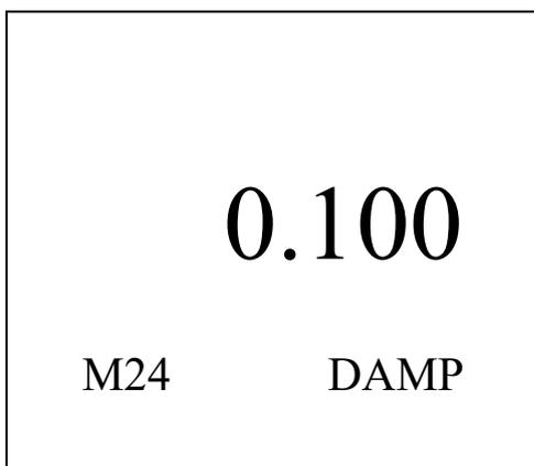
无需施加压力，模式代码显示区域 D3 显示 M24，单位/状态显示区域 D4 显示 DAMP，测量值显示区域 D2 显示当前阻尼时间。
